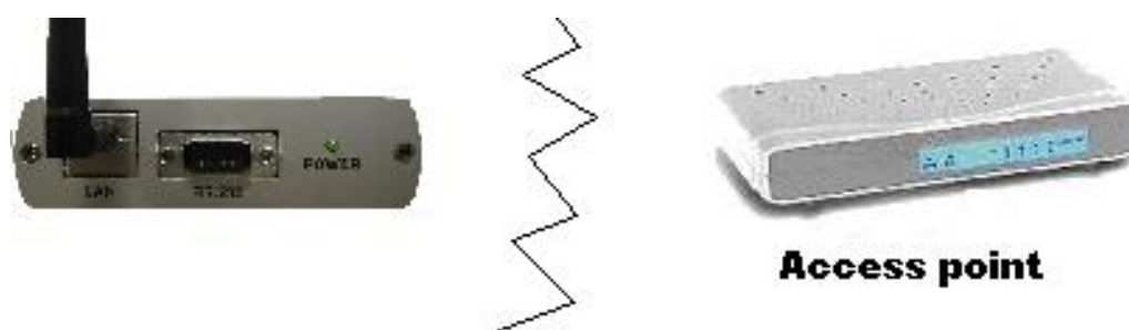
Figura 5: STE02W: Collegamento alla rete
